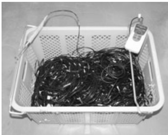
写真3 デジタルサーミスタ温度計。ケーブルは長さ600m、2m間隔にマークが付いている。
