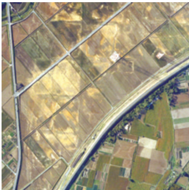
3. 小千谷市高梨町周辺の空中写真(写真は上がほぼ北西方向, 幅は約600m, 国土地理院撮影の一部). 長方形に白くなっている部分が陥没している. 圃場整備時に砂利を取り, 埋め戻したため, 道路部分が相対的に抜け上がっている.
