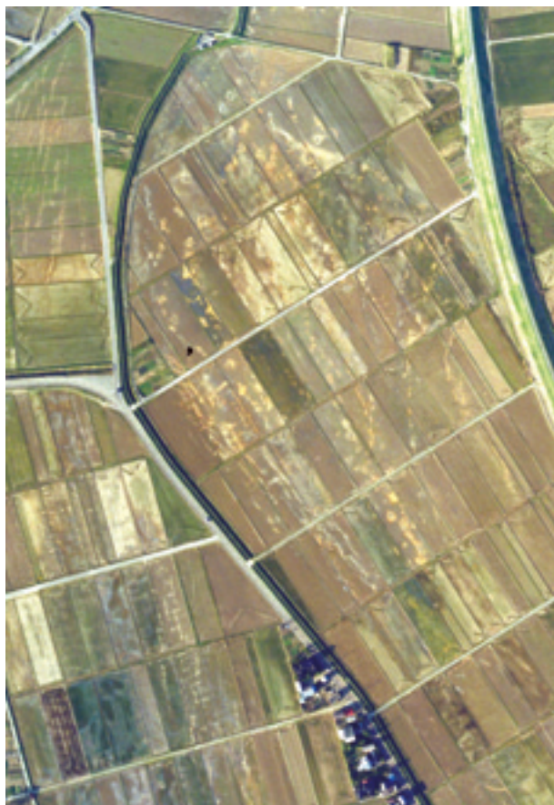
1. 長岡市新開町周辺の空中写真(写真は上がほぼ北方向, 幅は約600m, 国土地理院撮影の一部). 白く見えるのが噴砂列. 多くの線状型の噴砂がみられる.
