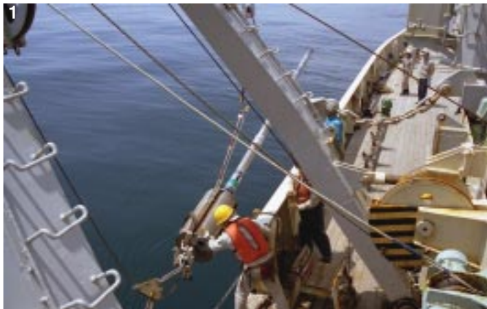
1 コアラー(柱状採泥器)の投入, [太平洋十勝沖 第二白嶺丸船上]
