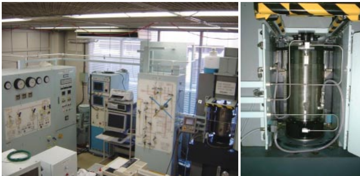
1. ガス圧式高温高圧変形実験装置(左:全景, 右:圧力容器). 高温(最高800°C)高圧(最高200MPa)環境下で間隙圧(最高200MPa)を制御しながら, 試料の変形実験, 摩擦実験, 物性測定ができる.
