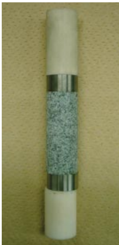
2. 変形実験前の花崗岩試料. 最大で直径20mm, 長さ50mmの試料の変形実験ができる.
