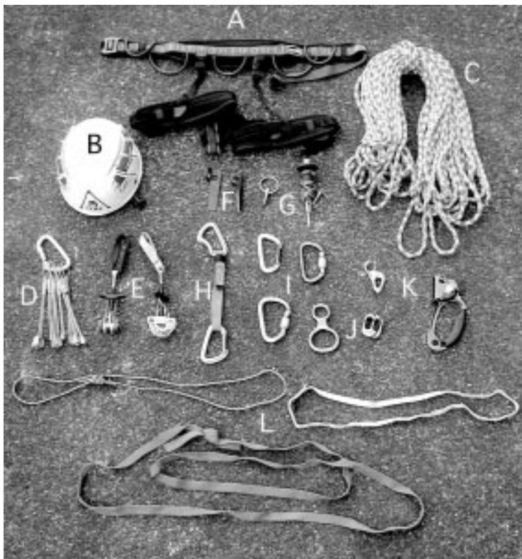
第1図 代表的なクライミングギア。A：シートハーネス、B：ヘルメット、C：ザイル、D：ナッツ、E：キャメロット、F：ハーケン、G：左はボルト、右はジャンピング、H：クイックドロ、I：カラビナ、J：下降器（左はエイト環、右はATC）、K：登高器（左はタイブロック、右はアッセンション）、L：シュリング。
