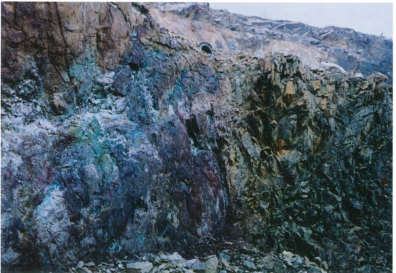
12. 溶脱帯下位の酸化銅鉱体. 銅二次鉱物は孔雀石と少量の藍銅鉱・珪孔雀石.
