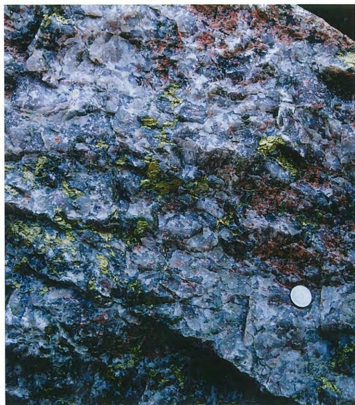
2. 黄銅鉱, 赤鉄鉱(+磁鉄鉱)からなる銅鉱石. コインは直径15mm.
