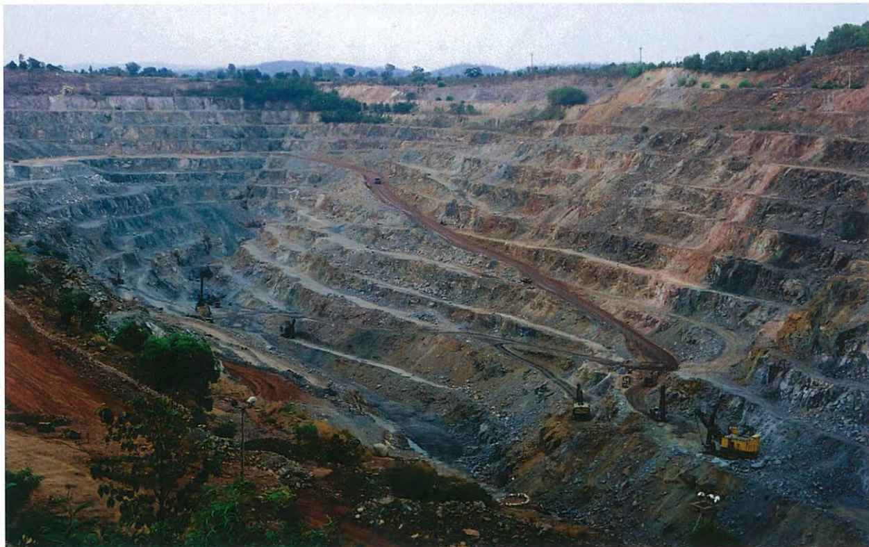
1. インド, マランジカンド鉱山の採鉱ピット. 南方を見る. ベンチ間隔(高さ)は基本的には15m.
