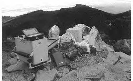
写真2 富士山頂、剣ヶ峰の三角点での重力測定。駒澤 正夫撮影。
