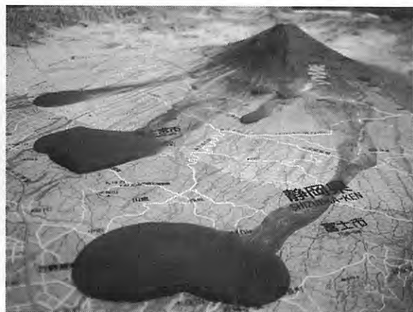
第3図 溶岩流のアナログ実験。溶かしたろうを立体模型に流して固まった溶岩流。流量や流す場所、地形の効果がよくわかります。
