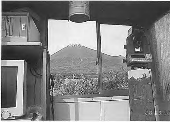
第13図 自動連続光波測距装置の例、栗倉(AWK)。右のコンクリート柱の上に光波測距儀を、左の棚に制御・記録・データ転送装置を設置。
