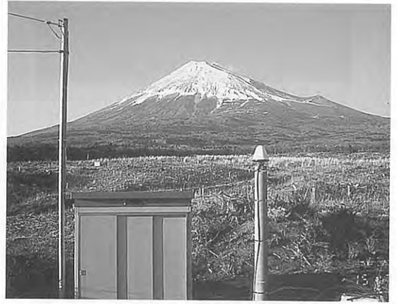
第7図 GPS連続観測点及び連続光波測距器械点, 栗倉(AWK).
