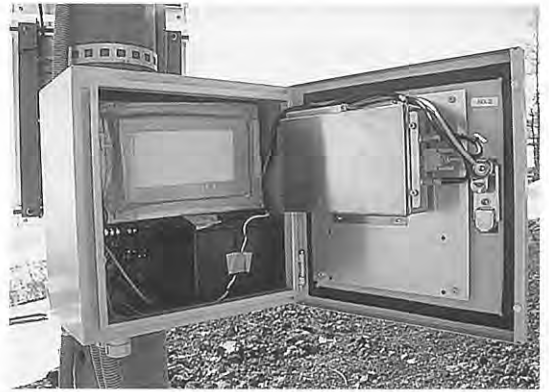
第18図 GPSの制御装置箱の中、本体の下が電源装置の一部(バッテリー)、上の発泡スチロールの箱の中に携帯電話装置一式が入っています。扉に取り付けてあるのが記録装置です。須走五合目観測点(SBF)。
