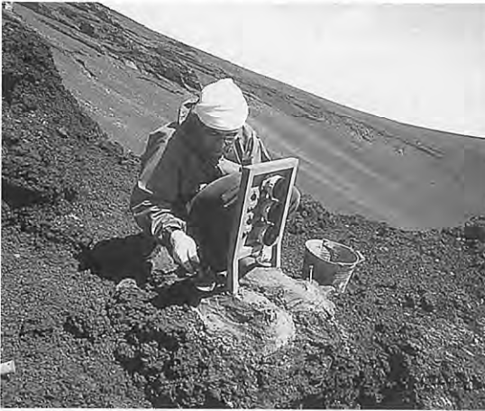
第14図 光波測距用反射鏡設置の例、露岩にモルタルで固定する場合、宝永火口西(HEW)。
