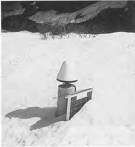
第10図 GPS連続観測点, スパルライン四合目(SLF). 春にはこのように雪の中に隠れてしましますが, 律義にもデータは送信され続けました.
