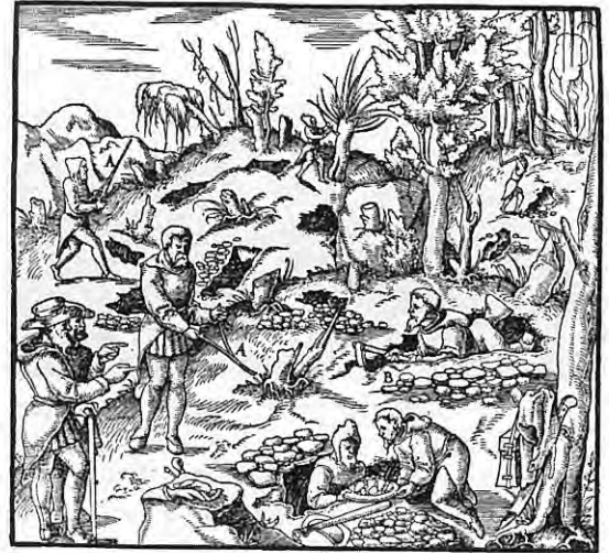
第6図 『デ・レ・メタリカ』の木版挿し絵。占い杖(探索杖 A)と試掘(B)。
