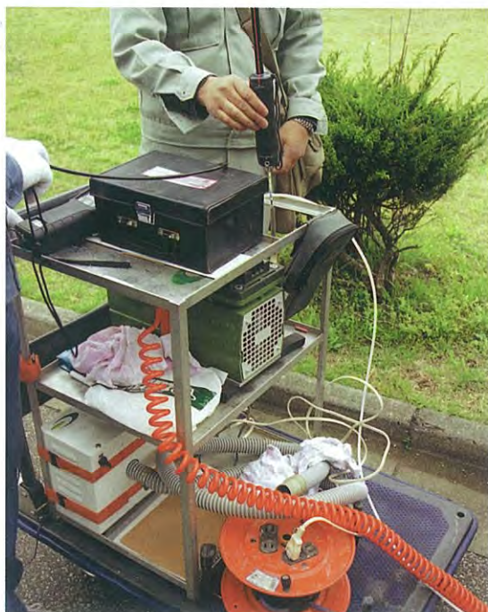
3. 揮発性有機塩素化合物による土壌汚染状況を調べるため、グランドエアシステムにより土壌ガスを真空ポンプを用いて吸引し、検知管の入ったガス採取器に導入する。
