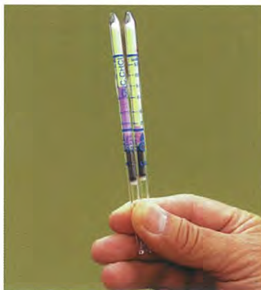
4. 揮発性有機塩素化合物により検知管の検知剤が紫色に変色している様子。
