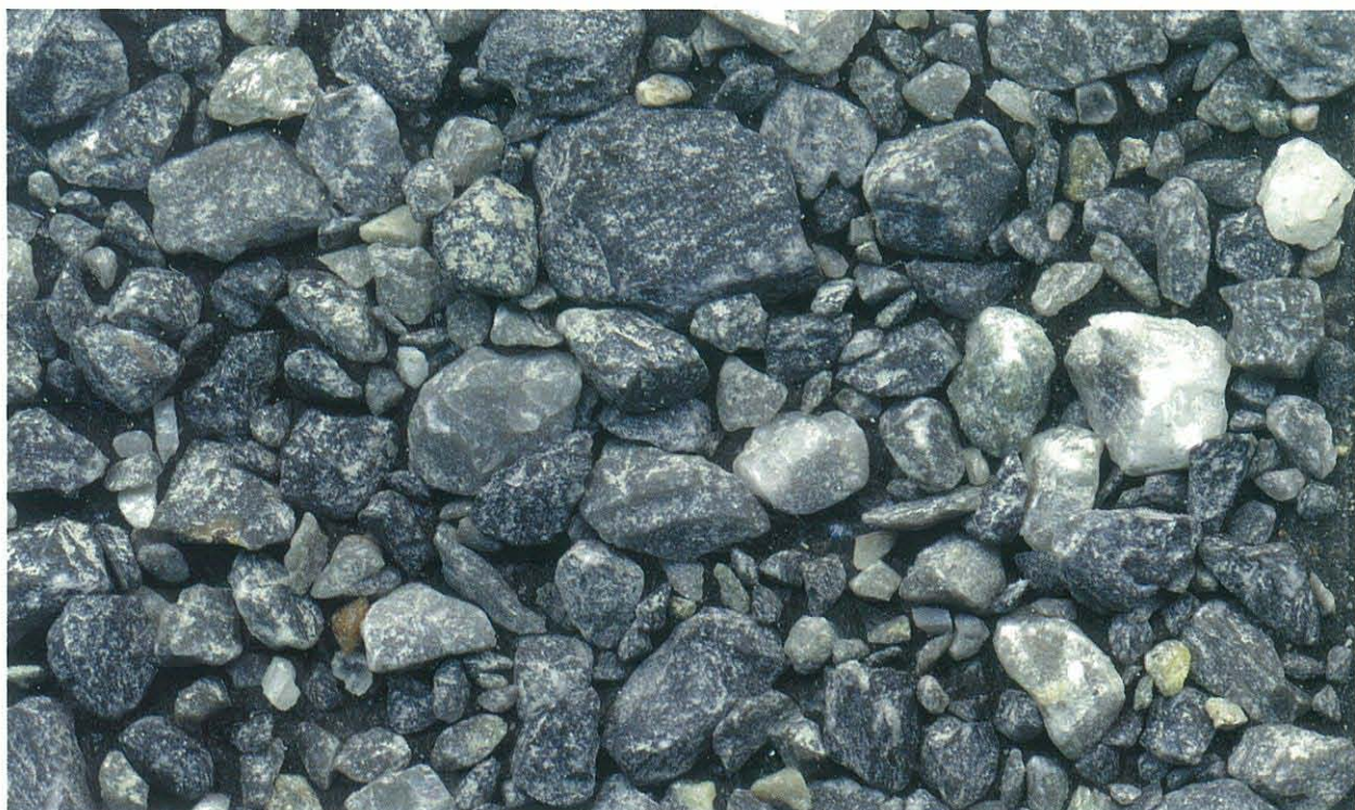
7. 砂岩碎砂の画像。青森県八戸地区で生産されたもの。碎砂は一般に角張った粒子であるが、この試料ではうまく角が取れている（画面の左右が約2.8cm）。
