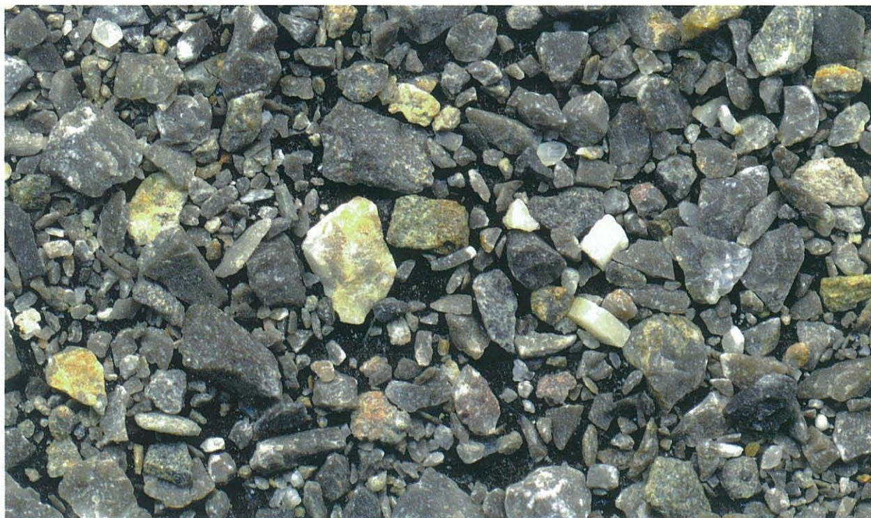
8. 石灰岩碎砂の画像。栃木県葛生地区産。石灰岩を砕いた碎砂は丸みを帯びた粒子が多い。しかし、小さな粒子には扁平なもの、角張ったものが多い（画面の左右が約2.8cm）。
