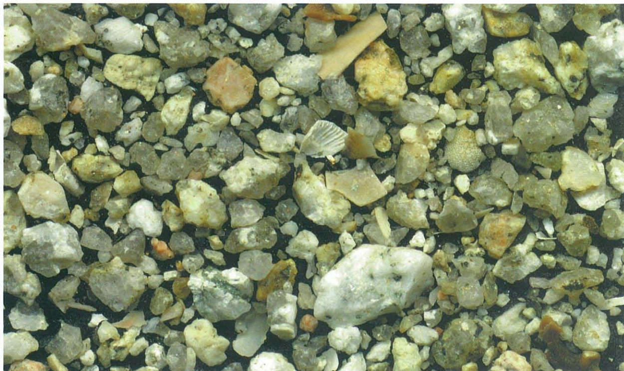
4. 海砂の画像。瀬戸内海・大三島沖で採取された海砂。瀬戸内海の砂は、円磨度が低く、花崗岩の真砂に近いのが特徴のようだ(画面の左右が約2.8cm)。
