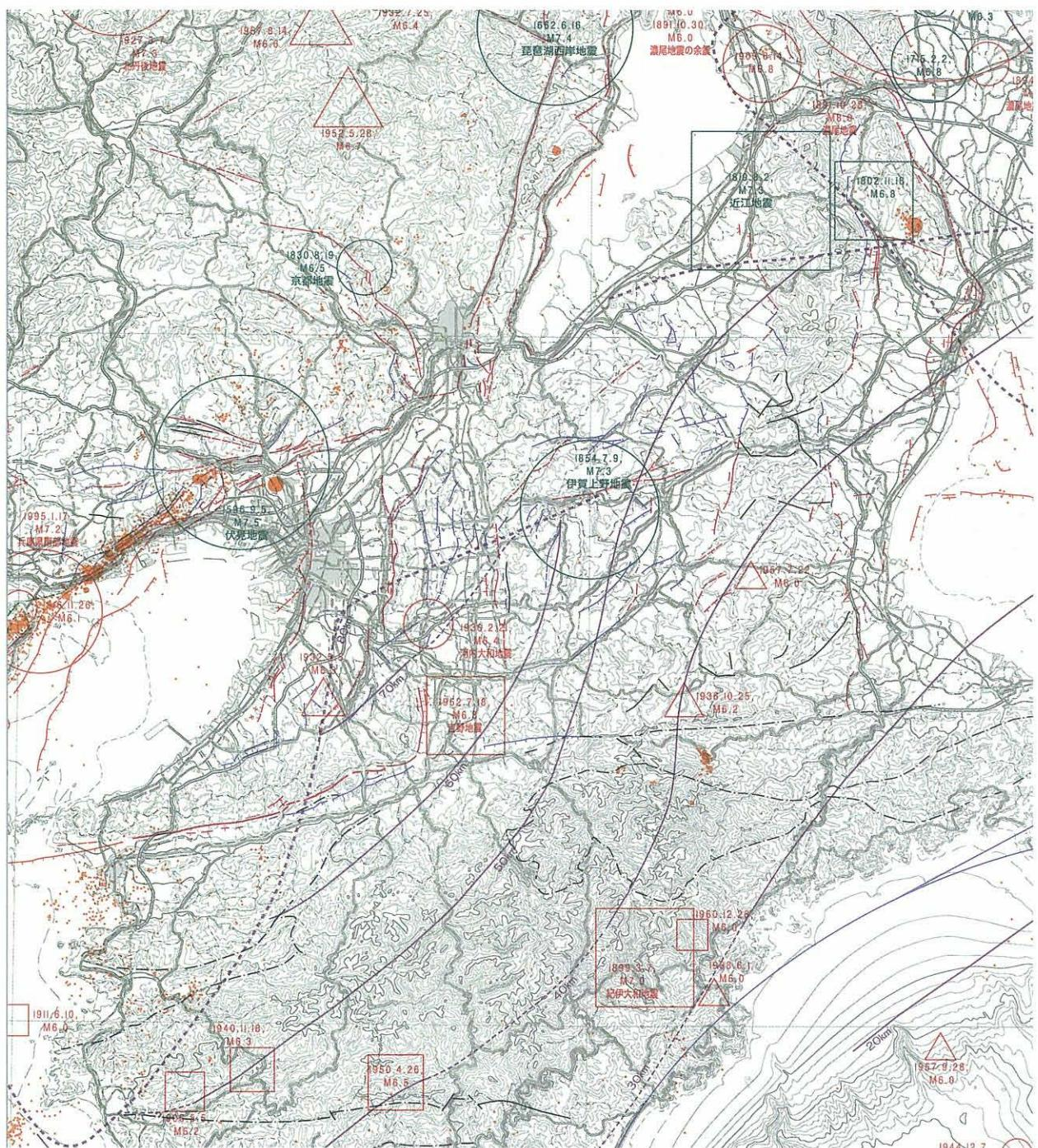
本図には、1995～1999年の微小地震（マグニチュード2.5～6）および16世紀以降の大地震（マグニチュード6以上）の震央を震源域の広さに比例する大きさの图形で表示した。オレンジ色の円が微小地震、赤色と緑の中空き图形はそれぞれ1885年以降および1884年以前の大地震である。円、正方形、三角形はそれぞれ震源の深さが30km未満、30～100km、100km以上であることを示す。南海トラフ沿いの巨大地震の震源域は青色の楕円で近似して示した。また、フィリピン海プレートの上面を藤色の等深線で示した。
