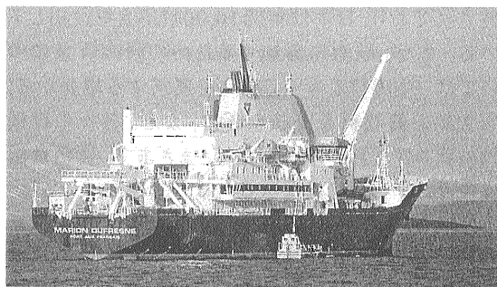
第1図 観測船Marion Dufresne (マリオン・デフレンヌ号)。この船はフランス極地研究所に所属し、総トン数8700、長さは120.50m、幅20.60m、喫水6.95mである。この観測船はIMAGESなどの海洋地質の研究のみならず、地球物理、海洋物理などの研究のためにも用いられる。
