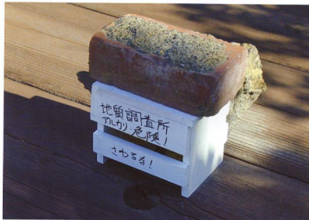
6. 火山ガス吸着器、アルカリ溶液および蒸留水を入れたボリ容器を、写真の箱の中に設置し、島内に漂う火山ガスを吸着させる、この吸着器を島内4箇所に設置し、溶液を定期的に回収・交換している。
