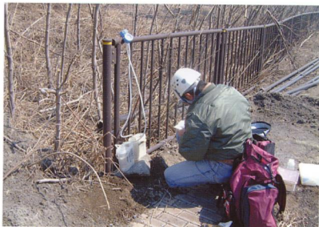
5. 火山ガスの現地採取。火山ガス組成から、噴火活動の推移を把握するため、陥没火口から流れ下ってくる火山ガスを島内で直接採取する(撮影 斎藤元治)。
