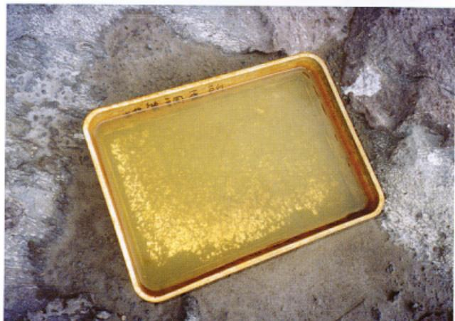
7. トレーを用いた降灰採取。降灰活動を確認するため、島内8箇所にステンレス製のトレーを設置し、定期的に内容物を採取し、構成物の分析を行っている(撮影 佐藤 努)。
