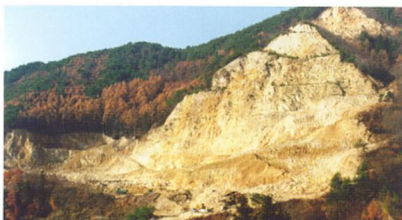
4. 東日本有数の規模を誇った信陽ろう石鉛山、真田一族ゆかりの長野県小県郡真田町にある。1937年に開山し、耐火物・農業・セメント原料を供給してきたが、1995年頃には採掘を終えた。採掘場の長径は約400m、標高差は200mほど、写真は盛んに採掘されていた1992年10月に撮影したものの。
