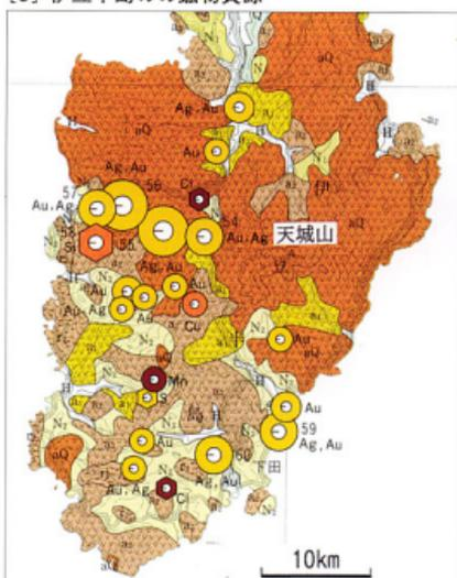
5. 伊豆半島の鉱物資源(鉱物資源図「関東甲信越」の一部)。金鉛床(黄色)が密集し、西海岸に伊豆珪石鉛床(ピンク色, No.58)がある。
