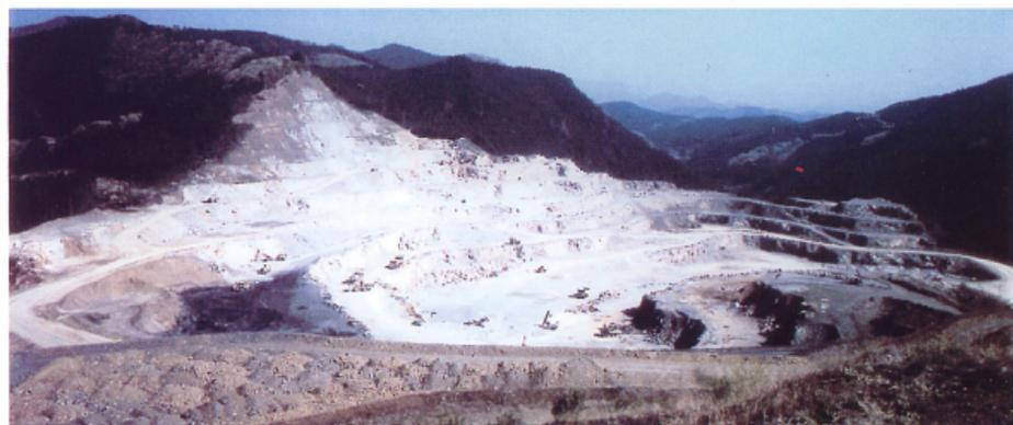
2. 葛生地区での石灰石の採掘(羽鶴鉱山)。羽鶴鉱山は日本を代表する石灰石・ドロマイト鉱山、昭和26年に採業開始し、既生産量は8,343万t、現在の年産は253万t、巨大な採掘場の長径は約1kmもあり、最も安全に、合理的に、自然に優しくを目標として採掘が進められている。採掘場の手前の部分は既に採掘を終え緑化されている(写真提供:日鉄鉱業(株)羽鶴鉱山)。
