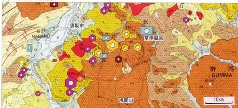
3. 上信地区の鉱物資源(鉱物資源図の一部)。多くの硫黄鉛床が分布するほか、画面の右上には鉄鉛床(No.21, 旧群馬鉄山)、左側には信陽ろう石鉛床(No.49)がある。
