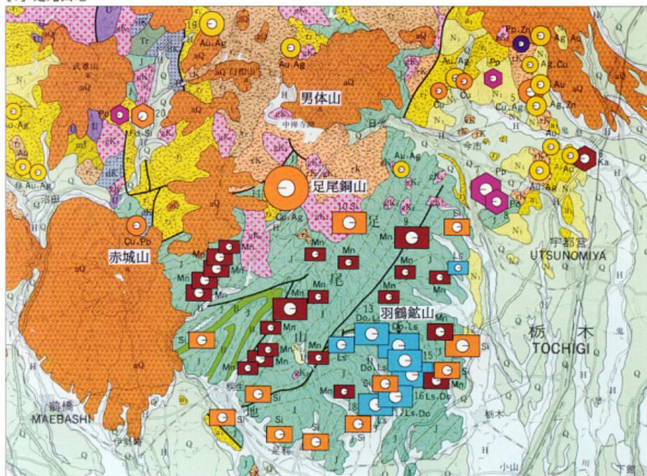
1. 足尾山地の鉱物資源(鉱物資源図「関東甲信越」の一部)。画面中央部の大きな丸が足尾銅山、その右下(南東側)に、マンガン銅床(茶色)、珪石銅床(オレンジ色)、石灰石銅床(青色)が密集している。
