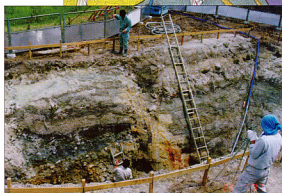
2. トレンチ調査で出現した柳ヶ瀬断層。はしごの左側では、堆積時にほぼ水平だった地層が断層によって引きずられ、垂直になっている。
