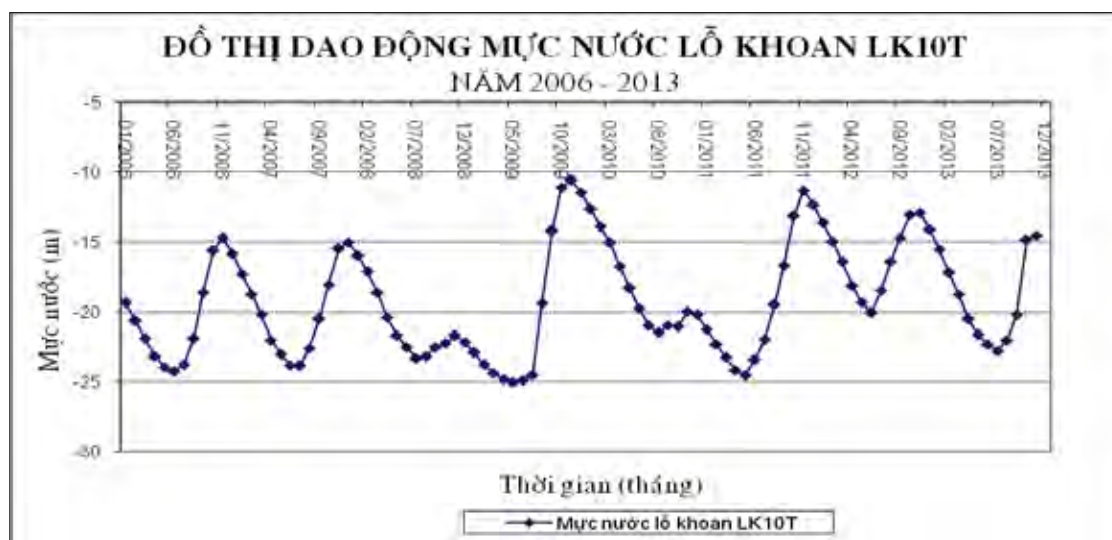
Fig. 11. Đồ thị mực nước theo mùa tầng chứa nước phun trào bazan Pleiku
