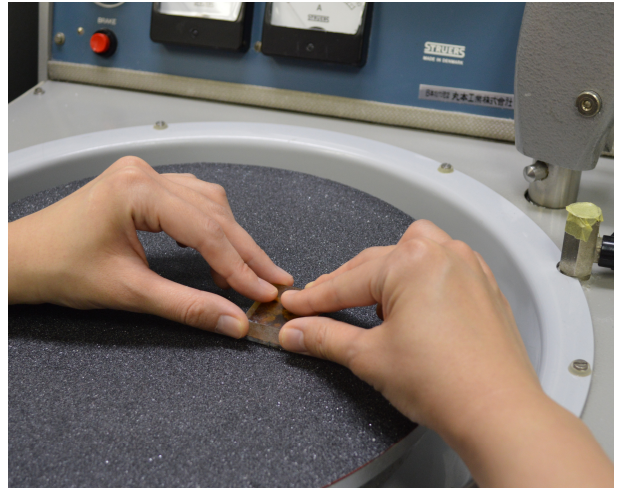
第2図 耐水ペーパーを装着した可変式研磨機で行う研磨。
