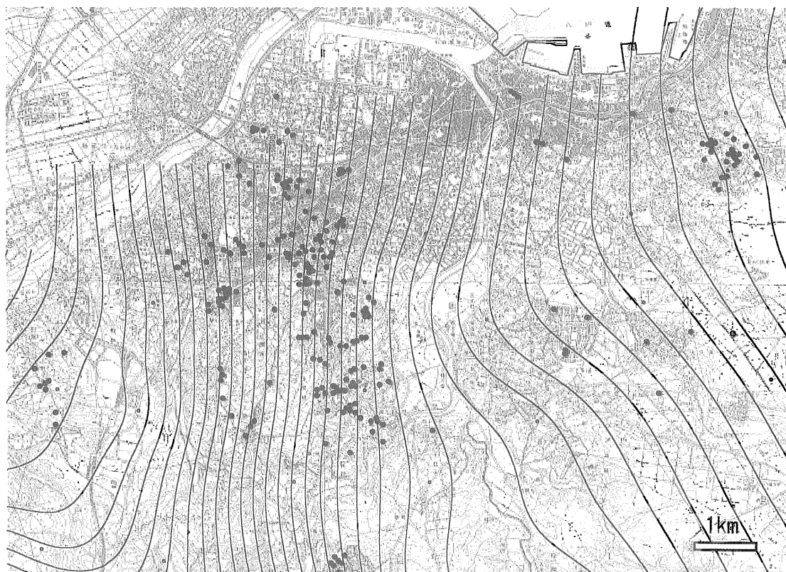
第7図 1994年三陸はるか沖地震の本震及び最大余震による八戸地域の住家被害と重力の概要図。 住家被害については、一部損壊以上の被害地点を●で示す。本図の被害には本震とその後の最大余震による被害を含む。重力は地質調査所(2000)における、本図の範囲20数点の重力値に基づく。等値線間隔は1 mGal( 10^{-5}\text{m/s}^2 )。基図には、国土地理院発行の2.5万分の1地形図「八戸西部」「八戸東部」「苫米地」「新井田」の一部を使用。
