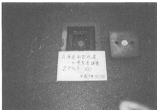
第3図 神戸市公共基準点の例。 中央のコンクリート升の中の金属標が測点。路線2-1の測点No.60。
