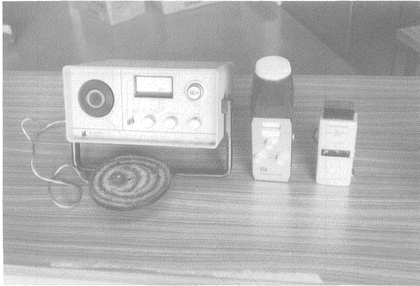
第1図 左より BISON 3101 型, KAPPAMETER KT 3 型および SCINTREX SM 5 型帯磁率計
