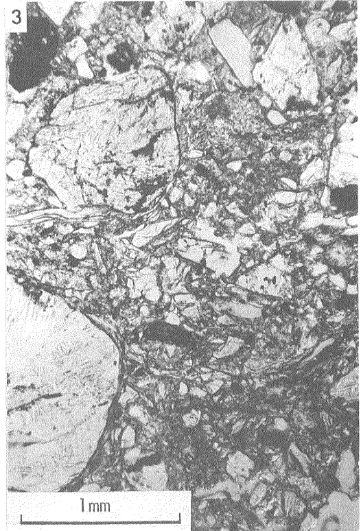
3. 円磨された蛇紋岩礫を含み，ほとんど蛇紋岩粒子からなる礫質砂岩（オープンニコル）
