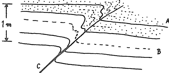
第5図-a 黒色片岩(A)および緑色片岩(B)互層の一部がZ字形に褶曲し、軸面(C)に沿ってわずかに差動している。
