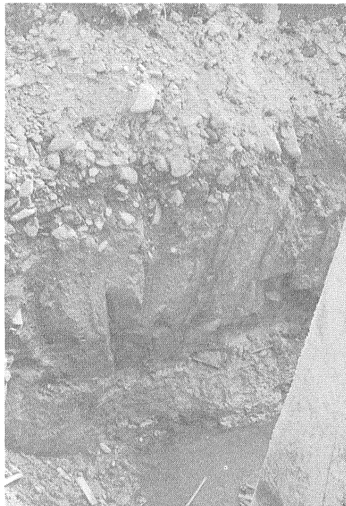
第11図 荒神岳西方，鰐川支流の架橋工事現場の掘下りに露われた木節粘土
