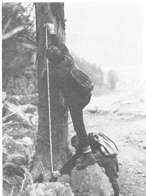
2. 本沢川中流部。杉の木の2.3mのところの幹に、8 cm×8 cm×5 cmの角礫凝灰岩の珎角礫がめり込んでいる。最高水位は、礫より約1.0m下方である。
