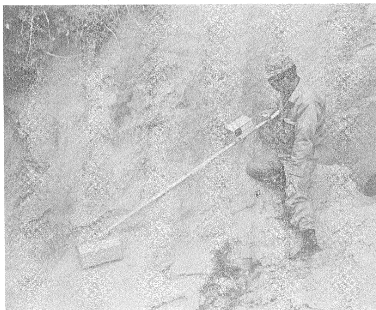
第1図 使用中の Portable Beryllium Detector-Model 300. 左下が検出器, 右上が計数器
