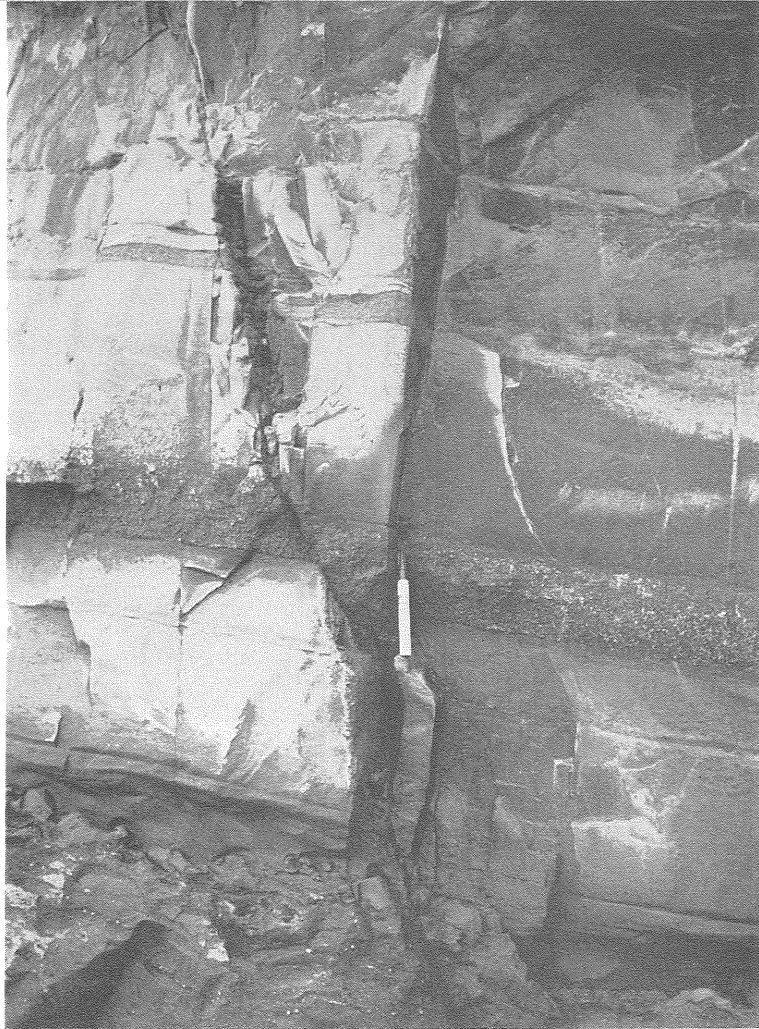
2 Y-NS系断層. シルトの中では急傾斜であるが、砂層中はゆるい傾斜を示す。
