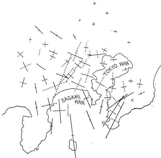
第18図a 三角点の変動から求めた歪楕円の主軸の分布図、実線—圧縮、点線—伸張 軸の長さは大体変位量に比例(Miyabe, 1931)
