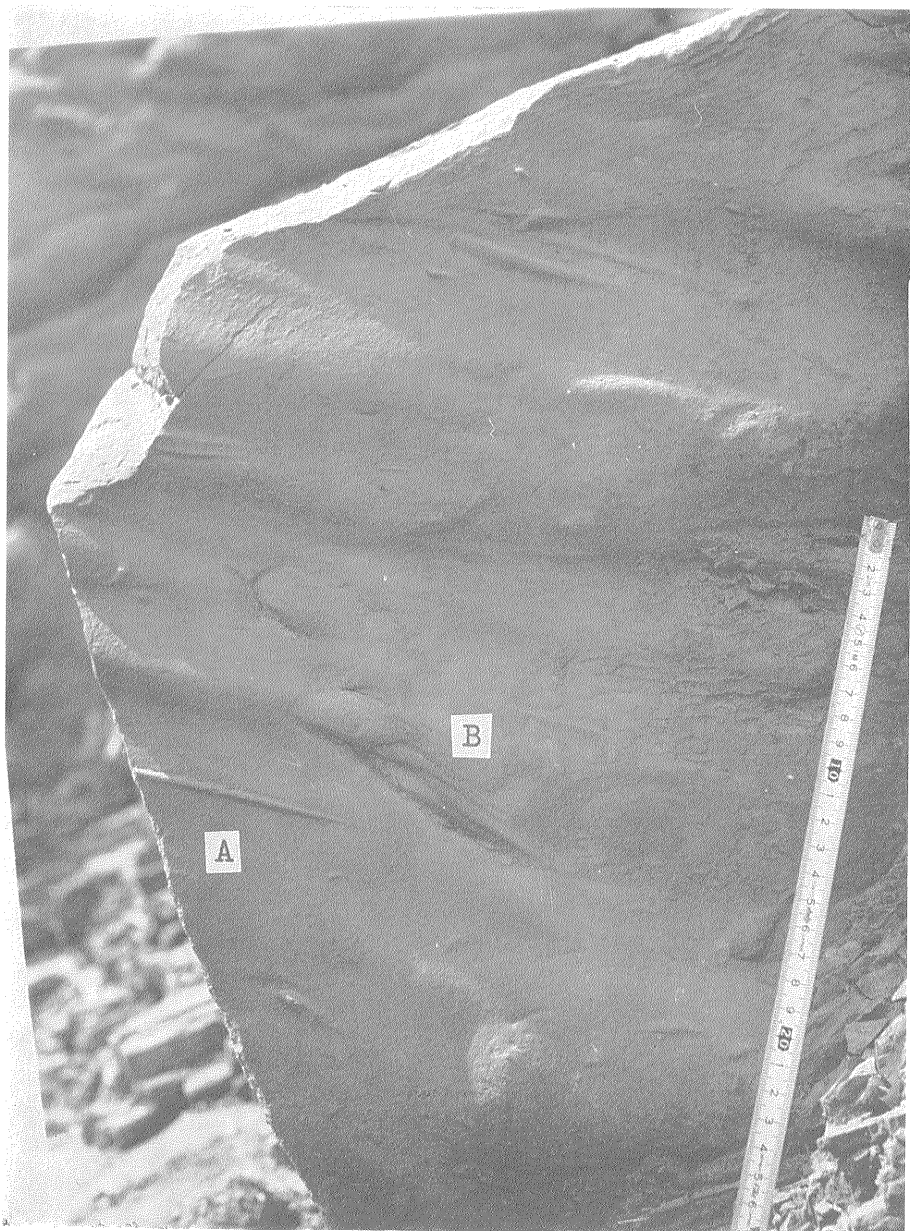
図版 8 groove cast (A) および brush cast あるいは groove cast の末端部 (B) 築別川支流の林道⑦ 川 端 層 流向は右から左へ
