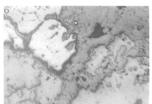
図版 6 硫化鉱物を交代する磁鉄鉱, 白: 黄鉄鉱, 淡灰: 黄銅鉱, 暗灰: 磁鉄鉱, 黒: 緑泥石, 反射, \times 70 , 立又鉱山
