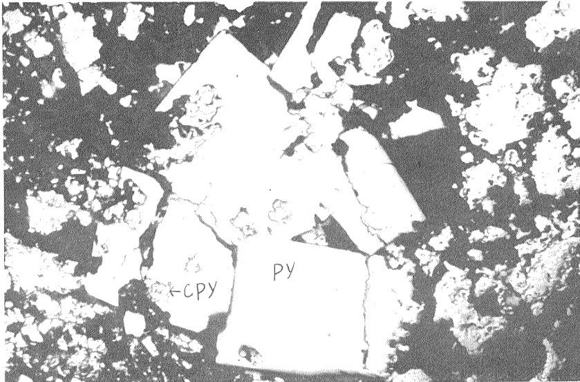
図版 5 結晶質黄鉄鉱 (py) 中のコロフォオルム状黄鉄鉱 (cpy) ×110
