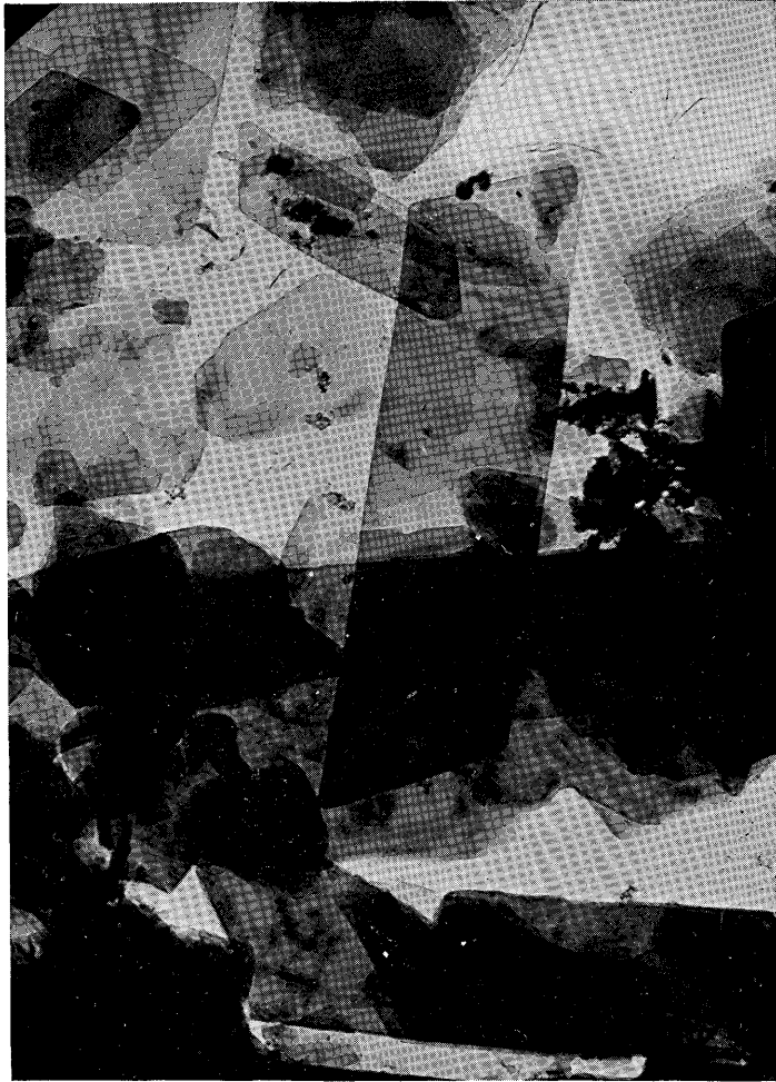
図版 5 葉蠟石の電子顕微鏡写真 Electron micrograph of pyrophyllite
