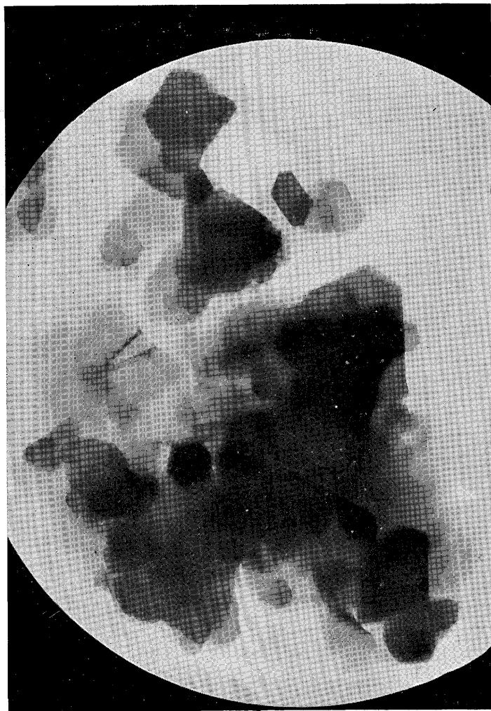
図版1 絹雲母の電子顕微鏡写真 Electron micrograph of sericite
