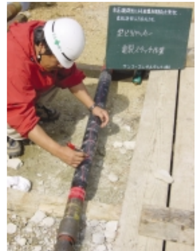
図2 応力測定用型取りパッカーによる孔壁亀裂の記録
