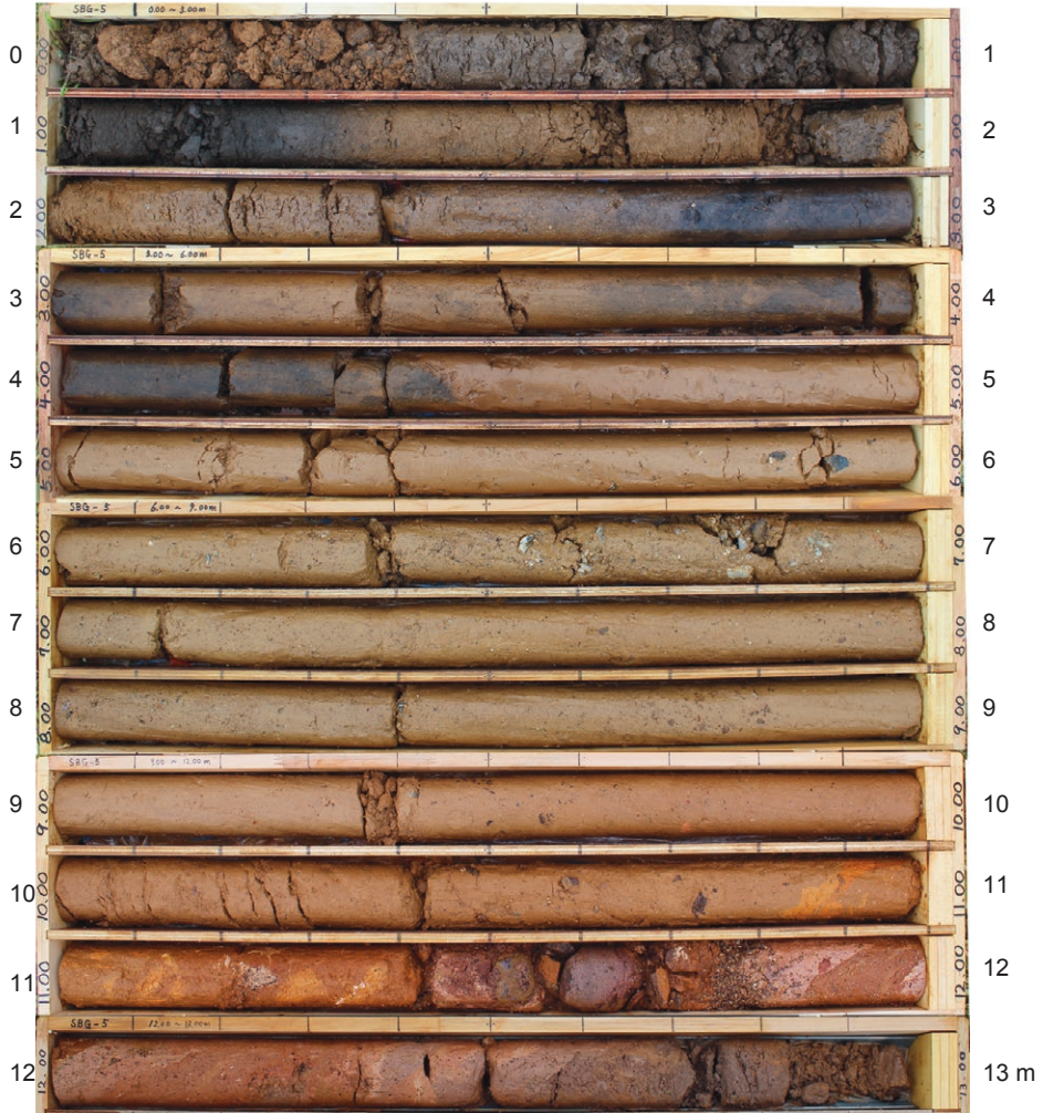
第6図. 続き. (D) SBG-4孔及び(E) SBG-5孔のボーリングコア写真. Fig. 6 continued. Photographs of boring cores of (D) SBG-4 and (E) SBG-5.
