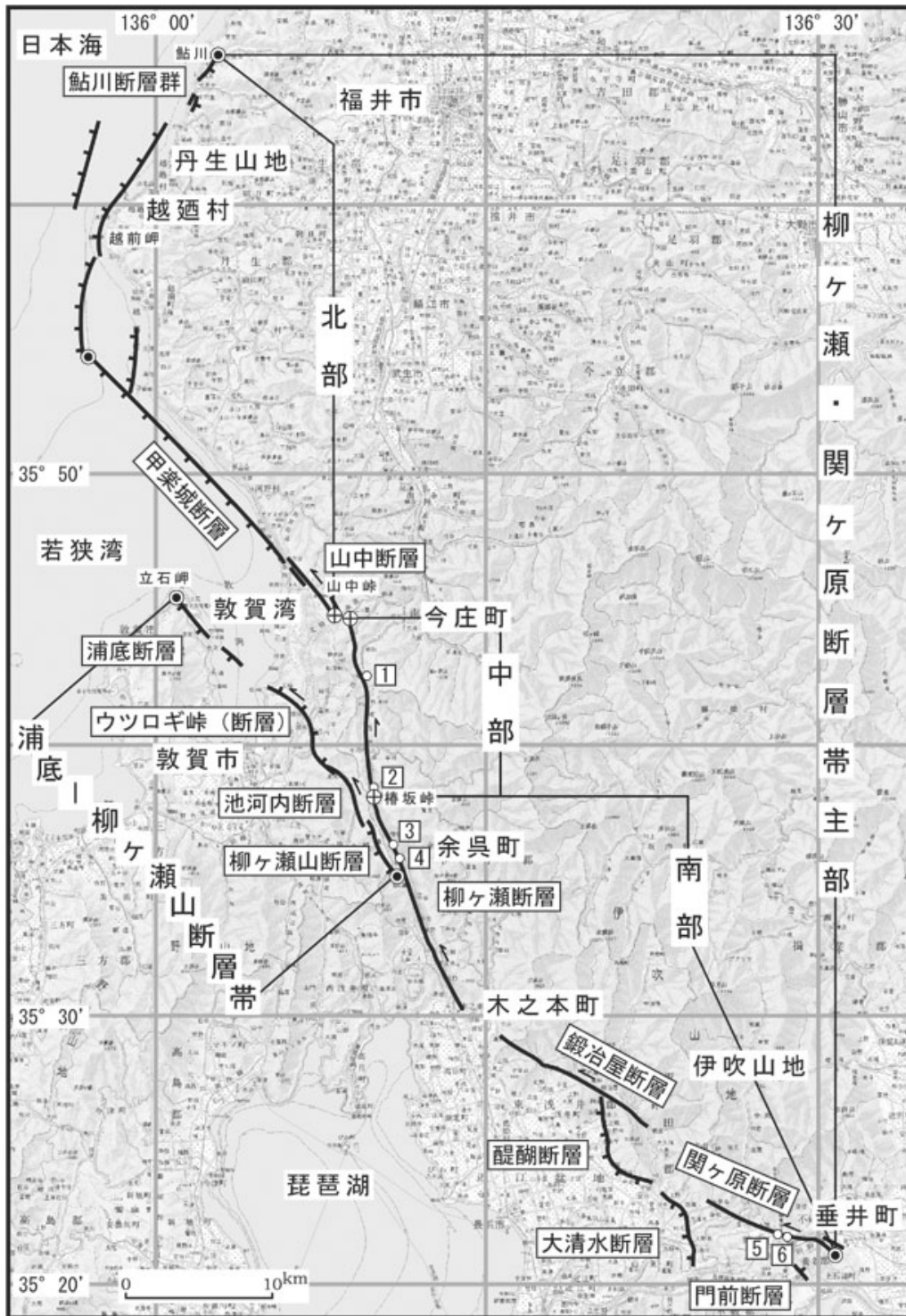
第1図. 柳ヶ瀬・関ヶ原断層帯と浦底-柳ヶ瀬山断層帯の位置と構成断層. 1: 清水洞地点, 2: 椿坂峠地点, 3: 椿坂地点, 4: 雁ヶ谷地点, 5: 丸山地点, 6: 秋葉地点. ◎: 断層帯の両端と屈曲点, ⊙: 断層帯の北部・中部・南部の境界. 地震調査研究推進本部地震調査委員会 (2004).
