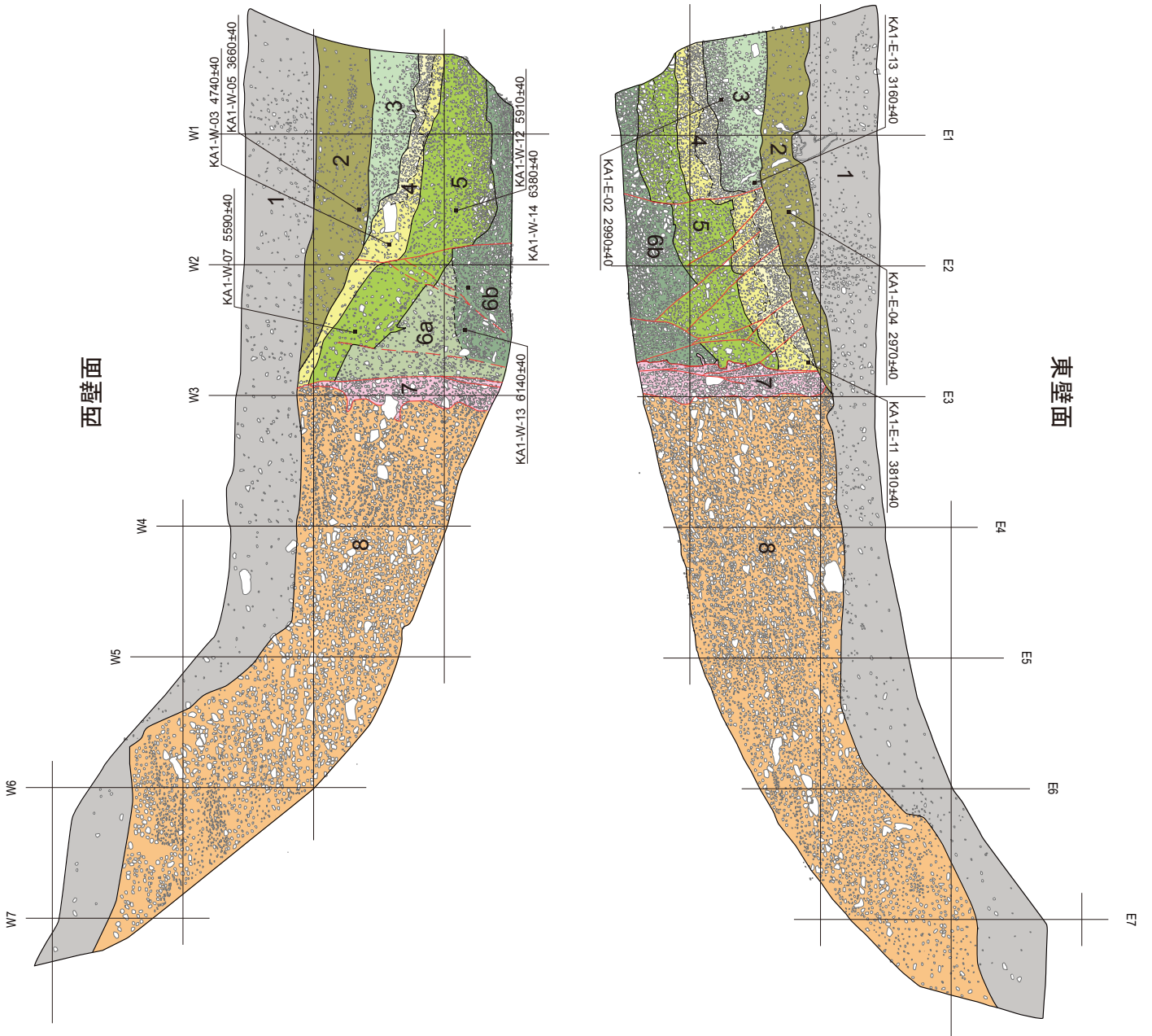
第6図. 鍛冶屋A1トレンチの壁面スケッチ. グリッドは鉛直面上で1m間隔. 年代測定結果の詳細は第1表参照. Fig. 6. Log of the Kajiya A1 trench. Grid interval is 1 meter on vertical plane. See Table 1 for more information about radiocarbon dates.
