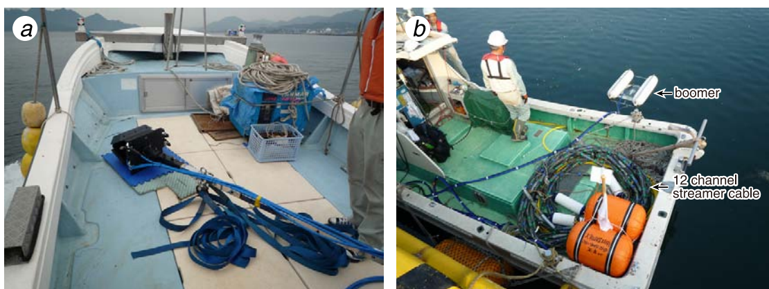
第4図. 海底地形測量およびマルチチャンネル音波探査に用いた装置. (a) インターフェロメトリ測深器 (GeoSwath Plus (英国 GeoAcoustic 社製)) および (b) ショートマルチ音波探査装置 (発振装置 (英国 Applied Acoustic Engineering 社製ブーマーシステム) と受信装置 (12チャンネルストリーマーケーブル). Fig. 4. Photographs showing equipments used for this study. (a) High-resolution wide swath bathymetric surveying instrument (GeoSwath Plus, GeoAcoustic Ltd., UK) and (b) short-multichannel seismic profiling system, including boomer plate (Applied Acoustic Engineering Ltd., USA) and 12 channel streamer cable.
