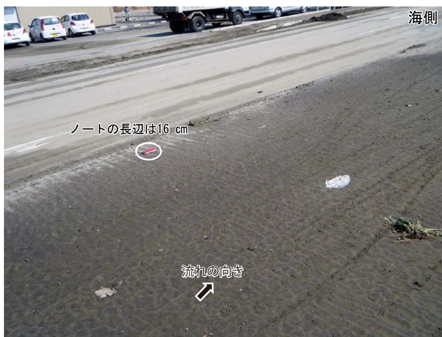
第7図. 海岸から500 m付近で見られるカレントリップル(2011/3/13). 表面をマッドドレイプが覆う. 戻り流れの痕跡. 浸水深は約70 cm.
