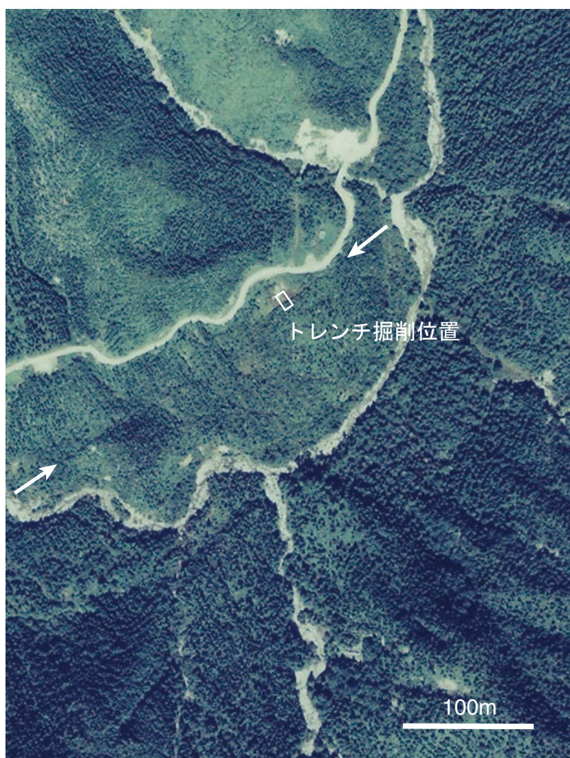
第25図. ヌクイ谷地点周辺の空中写真(拡大). 国土地理院撮影 CCB-77-8 C15-15 を使用. 矢印の間に直線的な逆向き低崖が見られる. Fig. 25. Air-photograph around the Nukuidani trench site taken by Geographical Survey Institute in 1977.
