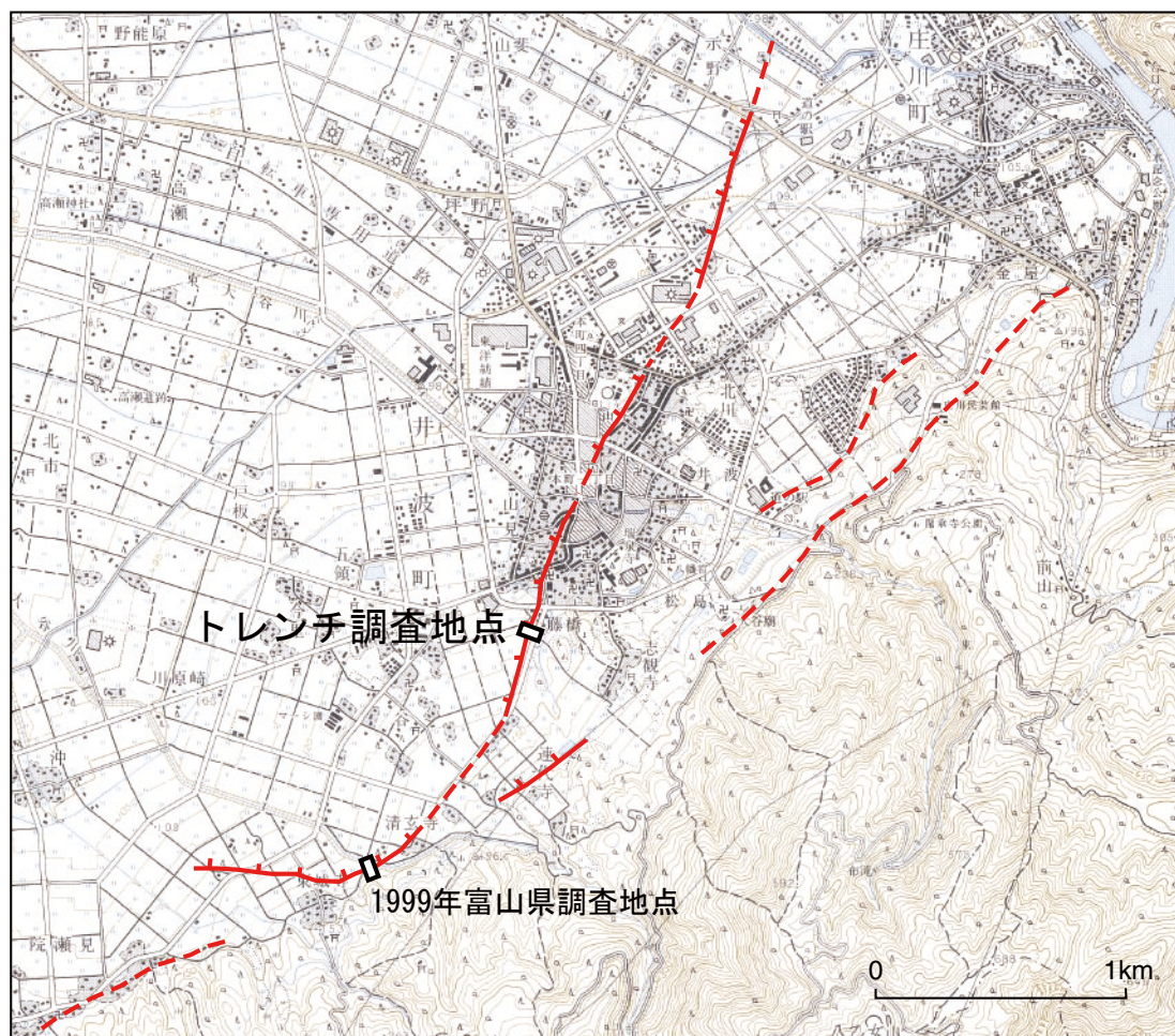
第2図. 山見地点周辺の活断層とトレンチ調査地点. 国土地理院発行 1/25,000 地形図「城端」を使用. 活断層の位置(破線は推定)は富山県(1998)に基づく.
