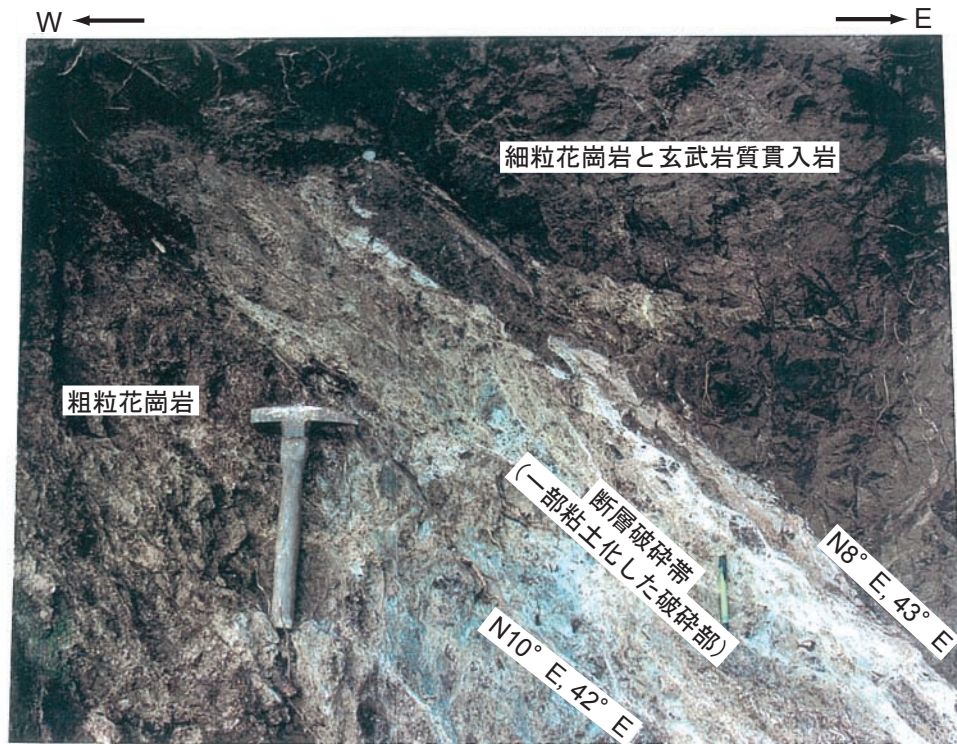
第3図. 伯耆町中祖の小町リニアメント上に見られる断層破碎帯の露頭。露頭位置は第2図参照。
