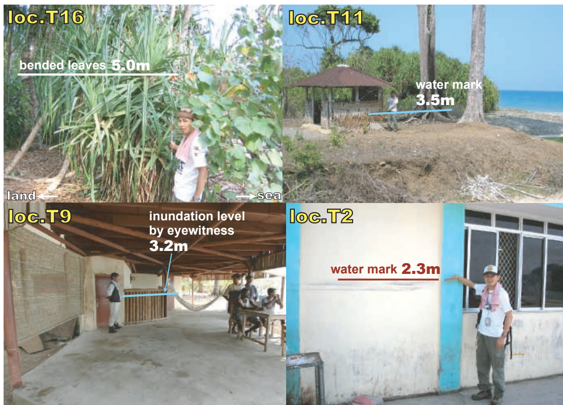
第 10 図. アンダマン諸島で見られる津波浸水痕と津波高. Fig. 10. Water marks and tsunami height in Andaman Islands.
