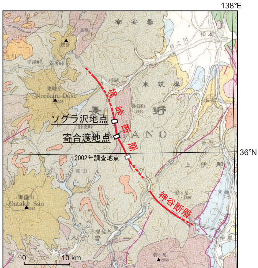
第1図. 境峠断層とその周辺の活断層. 1/50万活構造図「金沢」(加藤・杉山, 1985) の一部分に断層線を加筆.
