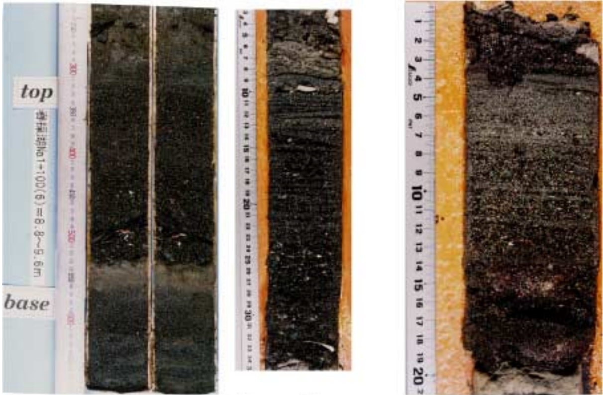
Site 1+100に見られるイベント堆積物Ts10の産状とその剥ぎ取り試料 (左: コア, 右: 剥ぎ取り試料)
