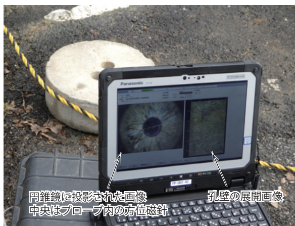
第 11 図. モニター画面. リアルタイムで孔壁の展開画像を見ることができる. プローブ内に設置された方位磁針で方位を一定に保ちながら画像を取得する.
