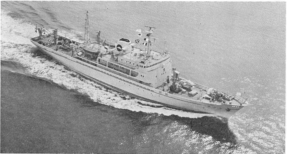
海洋地質調査船白嶺丸 (1821 t) Hakurei-maru (1,821 t), submarine geological survey vessel. 白嶺丸 (金属鉱業事業団所属) 全長 86.95 m 幅 13.40 m 深さ 5.30 m 総トン数 1,821,60 トン 航海速力 15.00 ノット 航続距離 15,000 カイリ 乗組員 35 名 研究員 20 名
