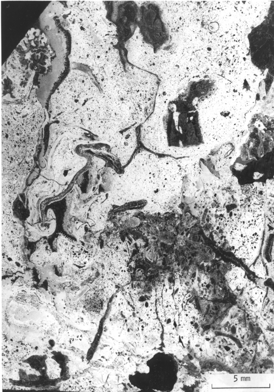
田原川石灰岩の塊状部の薄片写真（基質の大部分はミクライト状を呈している）
