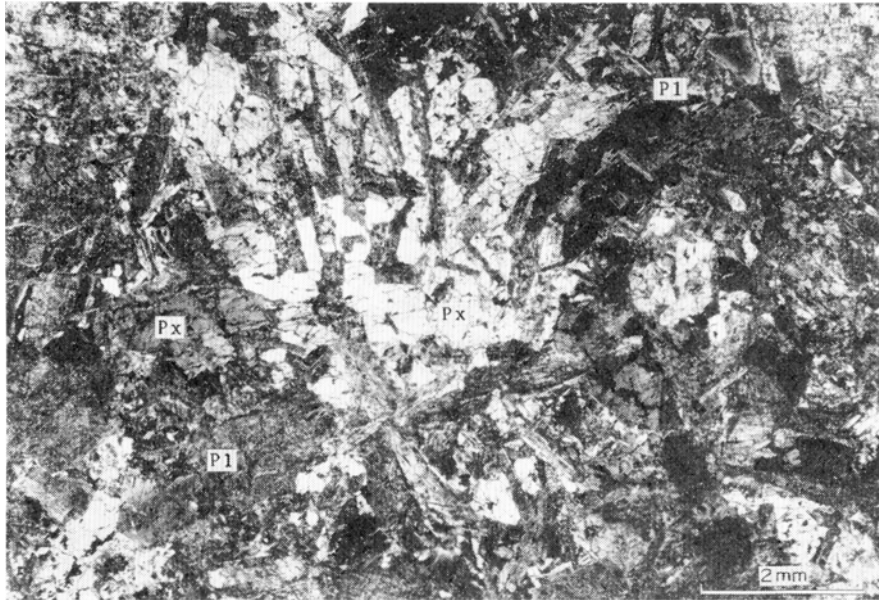
第12図 斑柘岩の顕微鏡写真（直交ポーラ），神門層，中崎。 Px：普通輝石(augite)，Pl：斜長石(plagioclase) Photomicrograph of gabbro of the Mikado Formation, Nakazaki. (Crossed polars)
