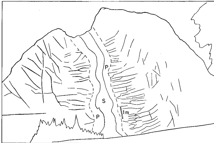
第 66 図 白岩山火砕流堆積物中のスパイラクル (犬飼町山内, 犬飼地域) S: 砂質の礫岩と火山灰の混合物。 P: 非-弱溶結の火山灰。 外側へ向かって強溶結部へ漸移する。 Pの外側は強溶結の火砕流堆積物で、スパイラクルへ向かって柱状節理が発達している。
